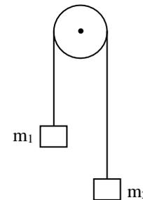
si on considère que la ficelle est inextensible et que la poulie est de masse négligeable. Pour déterminer une valeur expérimentale de l'accélération de la pesanteur, on réalise pour six hauteurs de chutes, la mesure de la durée de chute. Les données sont présentées dans le tableau ci-dessous :
