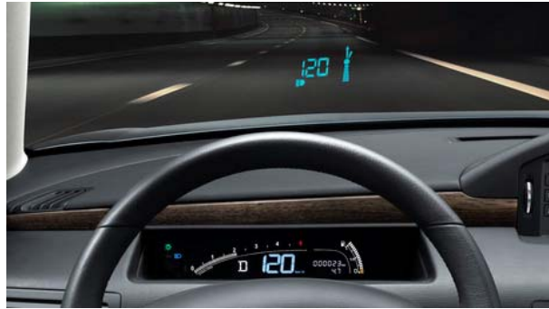
Figure 8. Vue du tableau de bord d'un véhicule muni de l'affichage tête haute
